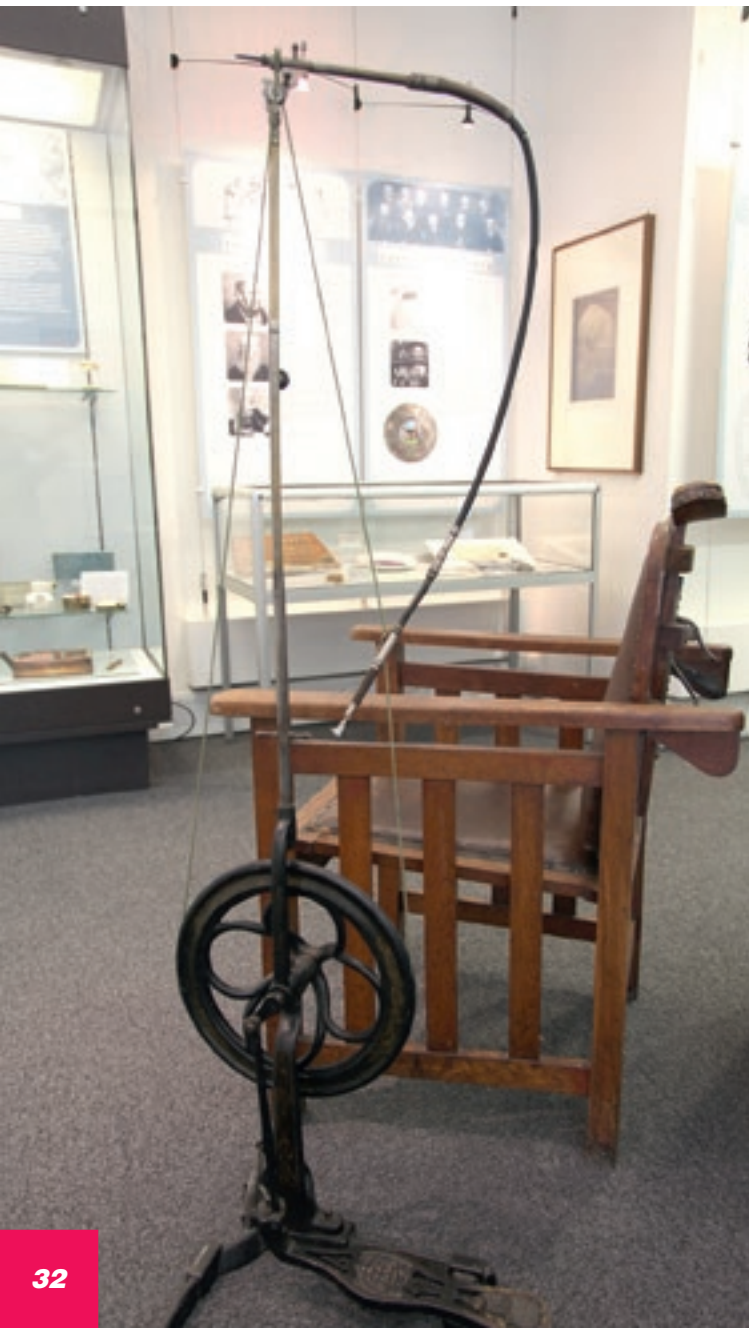
Бормашина с ножным приводом модели Моррисона, конец XIX века
